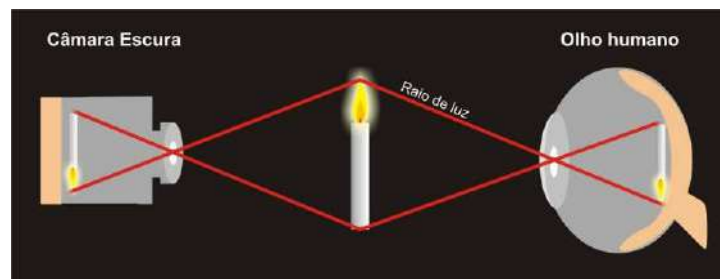
Figura 1 – O funcionamento do Olho e o princípio da Câmara Escura.
